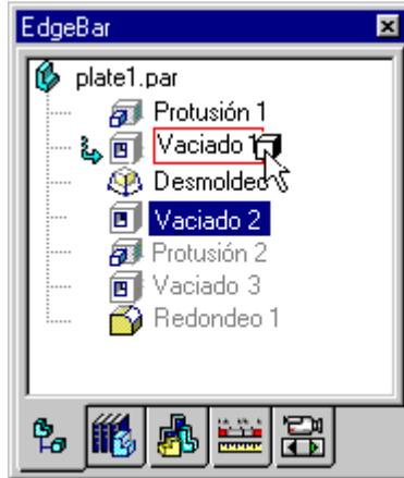
Una operación dependiente no puede moverse por encima de su operación antecedente. Por ejemplo: no puede mover un redondeo dentro del árbol de operaciones hasta un nivel situado por encima de la operación de borde en la que esté colocado. El redondeo no puede existir por delante de la operación que modifica.
