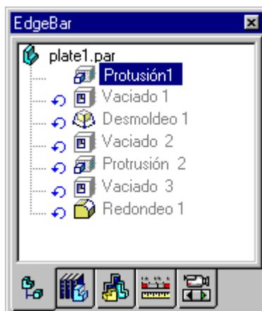
Puede entonces insertar una nueva operación como si la hubiera construido en ese punto del proceso de modelado de la pieza.
